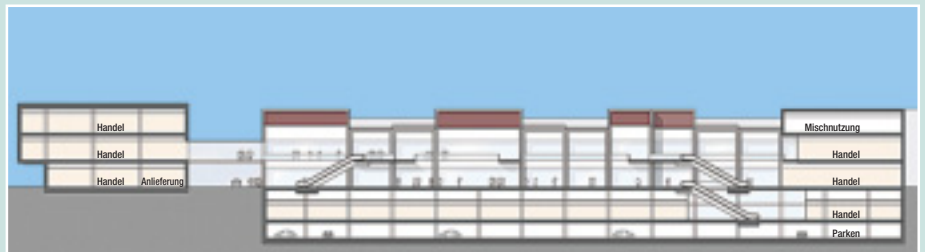
In der galerie GÜTERSLOH sind 3 Etagen für Einzelhandel mit insgesamt 17.000 qm Verkaufsfläche und rund 600 PKW-Stellplätze in einer Tiefgarage mit Zufahrt von der Eickhoffstrasse aus geplant. Ein Brückenschlag über die Einkaufsstraße verbindet beide Gebäudekörper.
